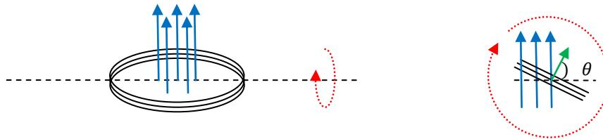
A f.e.m. pode ser calculada da lei de Faraday para  $N$  espiras,  $\varepsilon = -N \frac{d\Phi_B}{dt}$ , com  $N$  o n.º de espiras e  $\Phi_B$  o fluxo magnético através destas. Basta-nos então calcular o fluxo e depois derivar em ordem ao tempo.
