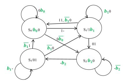
Um traço – representa ambas as hipóteses de uma variável, por exemplo 1- significa 10 e 11. Uma representação equivalente seria 10, 11. Pretende-se construir um circuito digital síncrono que implemente este diagrama, utilizando flip-flops tipo D.
