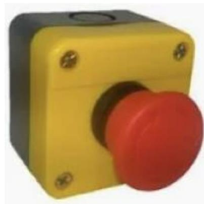
Serve para que numa situação de insegurança um operador da máquina pressione o botão. Estando este dispositivo ligado a um relé de segurança, o mesmo ir-se-á desativar, promovendo na máquina as ações para que a mesma fique segura. Usam-se normalmente vários cogumelos em vários pontos de uma máquina para que haja vários pontos para interromper as operações da mesma em situações de insegurança ou emergência.
