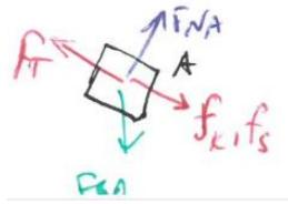
No limite de movimento temos  $f_s = f_s^{\max} = \mu_s F_N$ , sendo que neste caso a soma de forças segundo y ( $\Sigma F_y = 0$ ) leva a  $F_N = F_g \cos 30$ . Isto leva a
