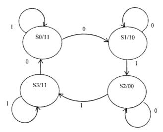
Pretende-se construir um circuito digital síncrono que implemente este diagrama, utilizando flip-flops tipo D.
